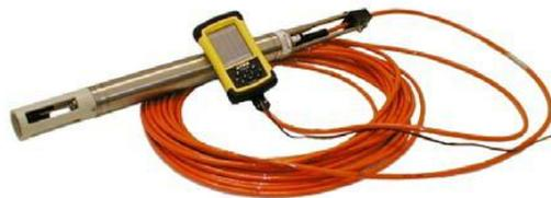
便携式数据读取装置通过内置的RS232C接口与OCEAN SEVEN 3XX CTD连接，并且专门开发了用于Windows Mobile™操作系统的软件：
